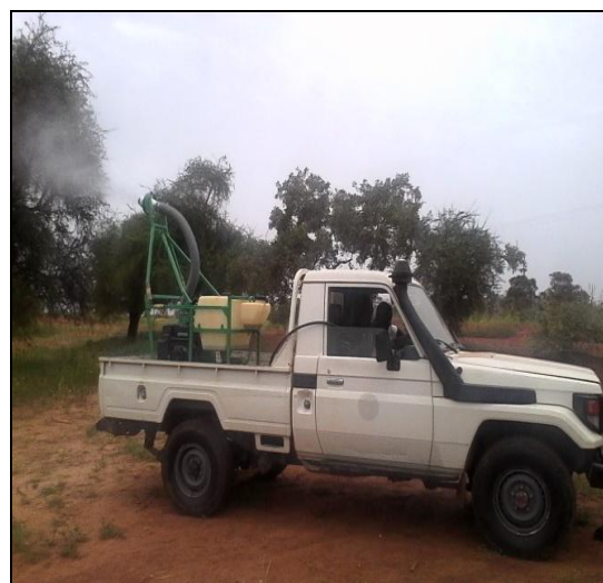
Traitement des dortoirs par un pulvérisateur de type AU 8115 porté par un véhicule
